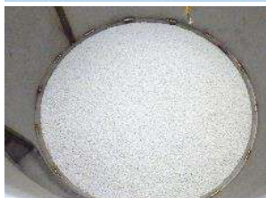
蓄熱材充填状況
